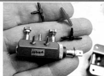
Распределительный вентиль пневмосистемы. Регулировочными винтами можно устанавливать скорость выпуска шасси. Рядом видны тройники для соединения воздушных шлангов системы
