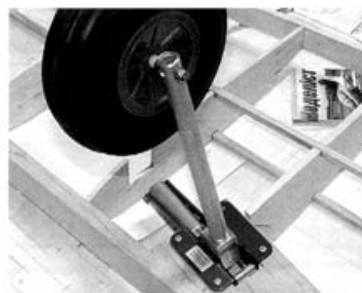
Компактный механизм шасси с пневмоцилиндром, установленный в крыле модели
